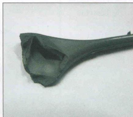
Figura 6 - Defeito de jateamento em um corpo de prova
