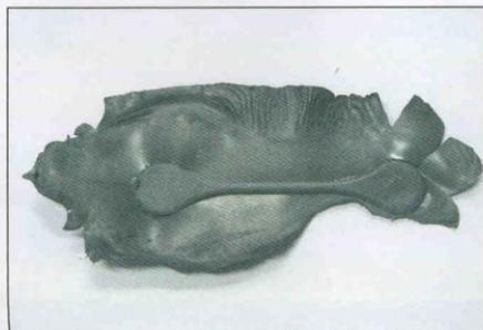
Figura 4 - Peça com excesso de rebarba
